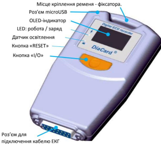
Електронна схема реєстратора виконана за модульним принципом. Кожен модуль є автономним закінченням вузлом, що працює під управлінням окремого мікроконтролеру і спеціально розробленого програмного забезпечення (ПЗ).
