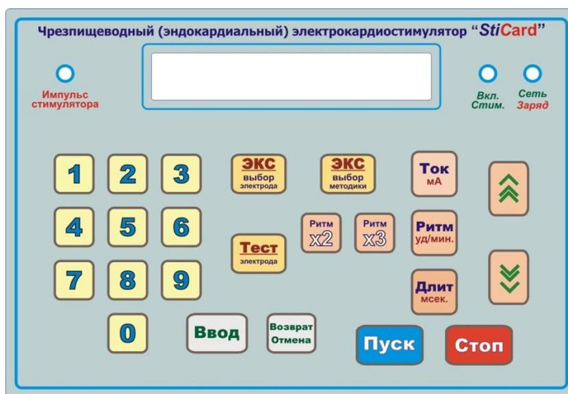
Рис.1 Расположение кнопок на клавиатуре стимулятора
